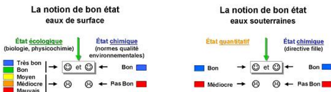
Figure 3 : Notion de bon état pour les eaux superficielles et souterraines
