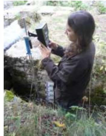
*Mesure du débit à l'aide du courantomètre:*
