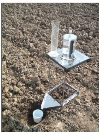
Appareil de mesure de la sensibilité des sols à l'érosion
