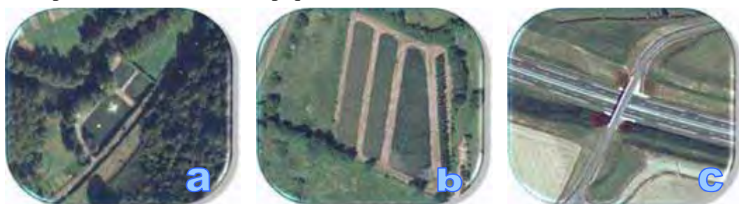
Fig. 64 : Types des zones humides artificielles : (a) station d'épuration, (b) bassins de lagunage, (c) bassins de rétention
