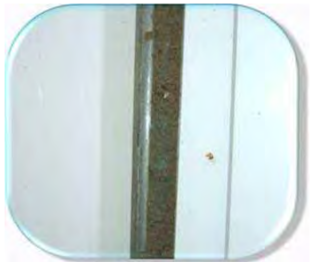
Fig. 70 : Utilisation de l'Agro-sonde A3H et type d'échantillon (carotte de 80cm)
