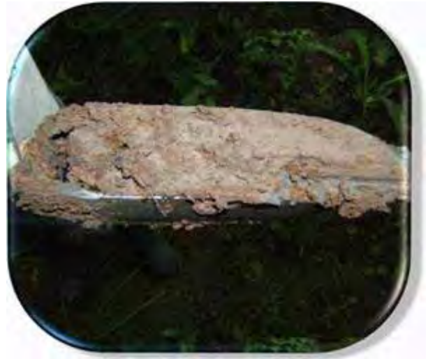
Fig. 69 : Utilisation de la tarière et type d'échantillon (prélèvement par 20cm)
