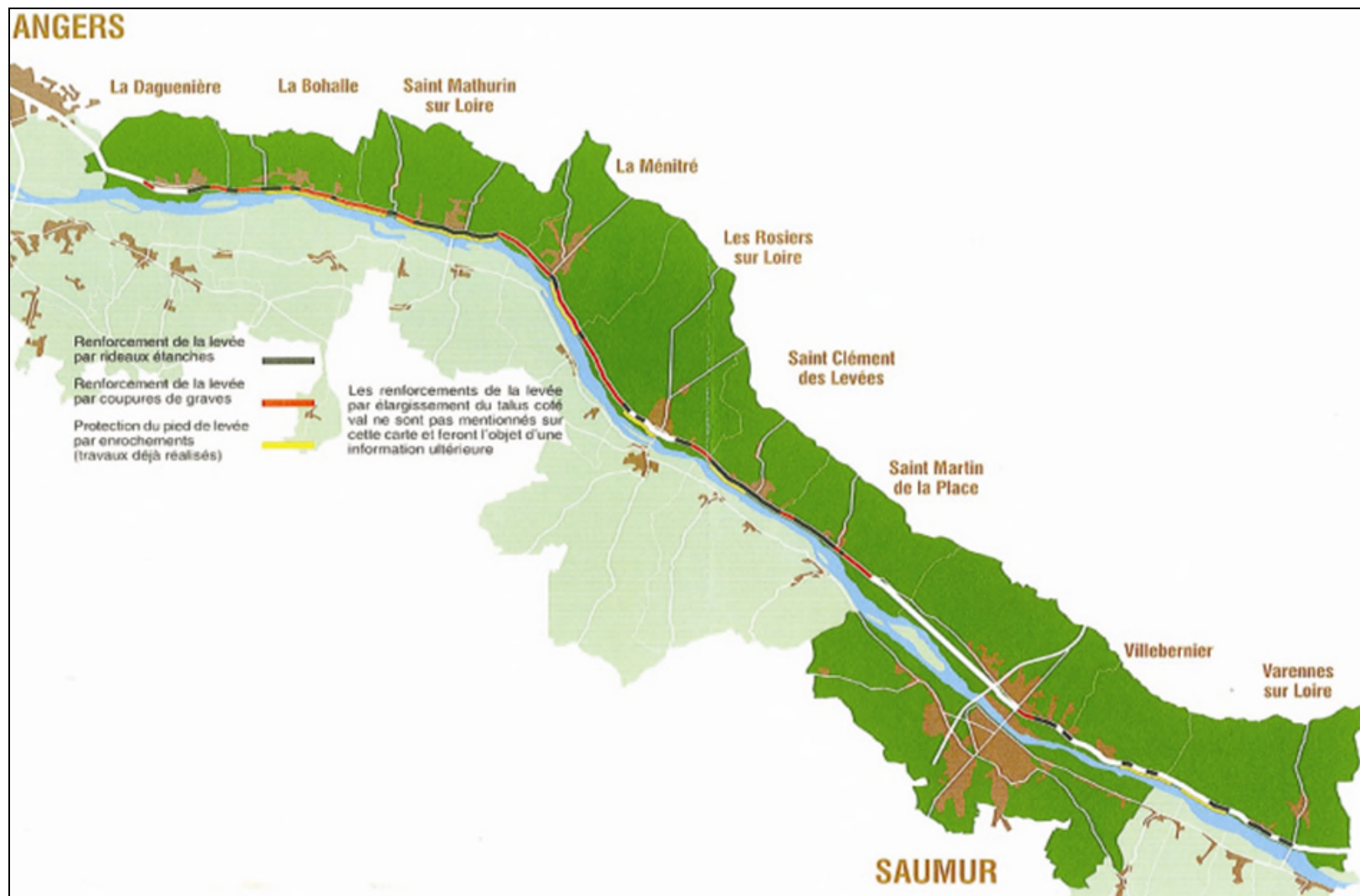
Figure 89: Types d'aménagement pour le renforcement de la levée du val d'Authion
