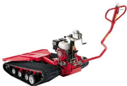
Le « Cheval de fer » est une brouette motorisée. La configuration du « cheval de fer » permet d'adapter différents outils comme un broyeur, une petite grue, une benne ou tout autre matériel nécessaire à l'intervention sur les chantiers en rivière. Équipé de deux chenilles de 40 cm de large, il est particulièrement manœuvrable et léger. Son impact sur le milieu traversé est très faible grâce à une très bonne répartition des charges.
