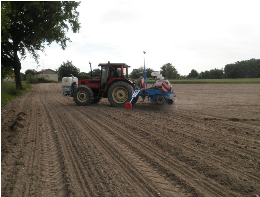
Essai semis de maïs avec désherbage localisé sur le rang
