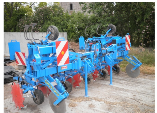
Bineuse équipée d'une rampe de pulvérisation localisée
