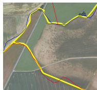
le tracé de la BD Carthage est mauvais à la même échelle que celle de la BD TOPO (en jaune). Selon la largeur du « buffer », la qualité du tracé peut avoir une importance.
