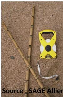
La largeur des ouvrages a été mesurée à l'aide d'un décimètre.
