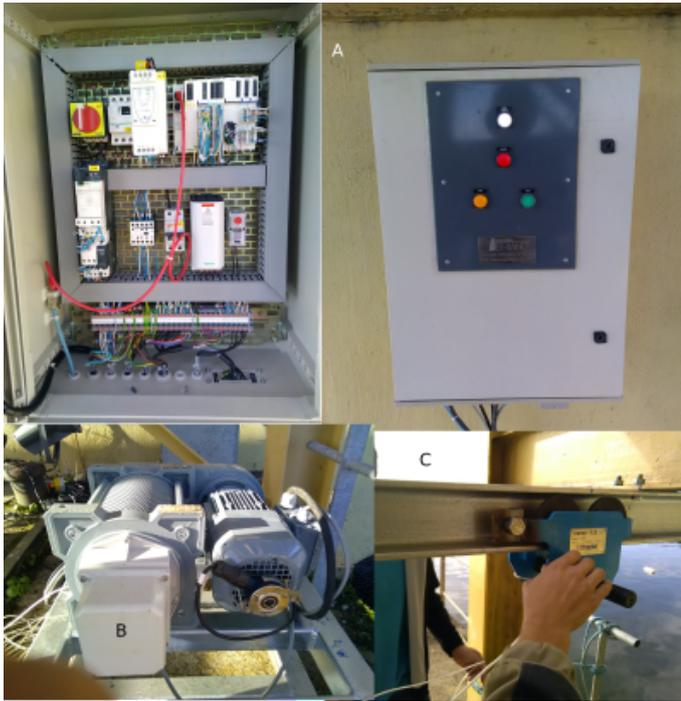
FIGURE 6 – A Armoire électrique de commande de l’automate, déportée sur la pile, B treuil avec codeur incrémental, C chariot de levage et de positionnement du DIDSON (pour la sécurité).
