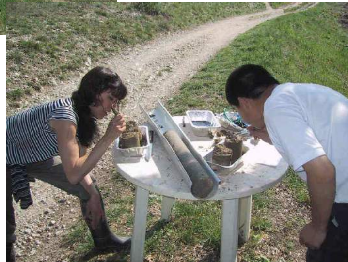
Mesure des densités de racines fines profondes des arbres par carottage
