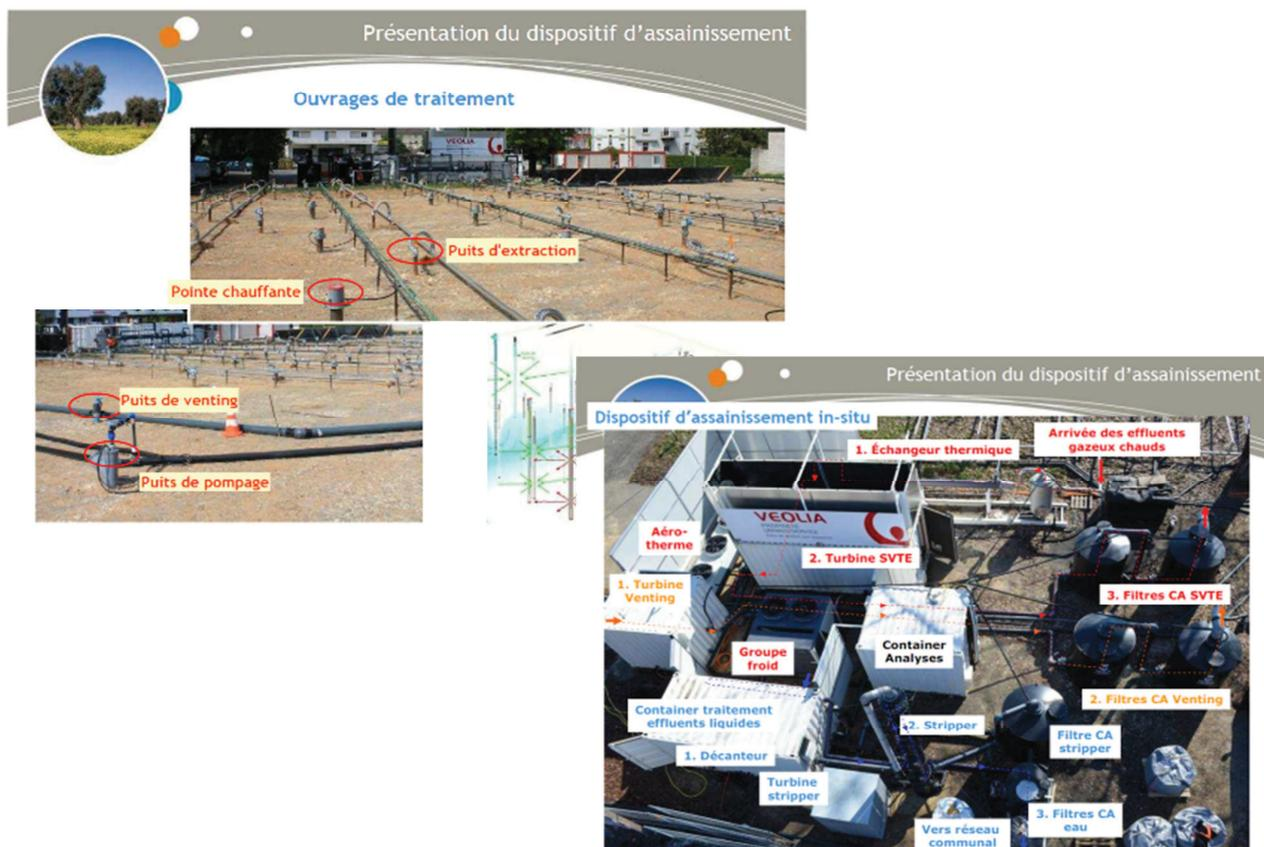
**Figure n°14: Assainissement par extraction thermique de vapeurs du sol (SVTE)**
