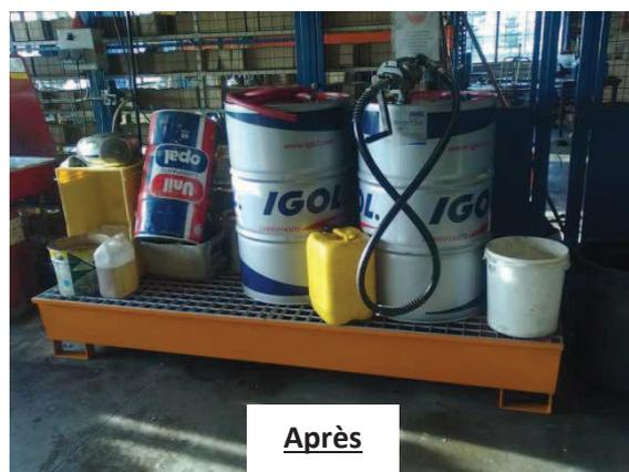
Figure n°13: Mise en place d'un bac de rétention
