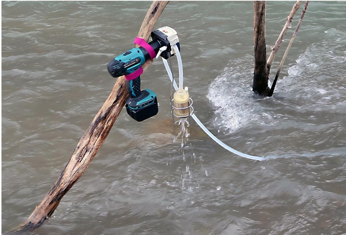
**Figure 2 :** exemple d'échantillonnage par pompage dans le cours d'eau et filtration à l'aide de la capsule dédiée.
