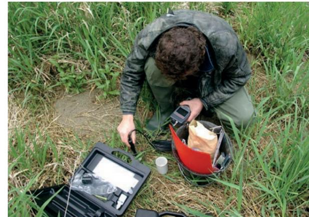
Des suivis physico-chimique de température, oxygène dissous, turbidité, nitrates... ont été réalisés durant plusieurs années. Ces éléments de diagnostic autorisent une comparaison entre les annexes fluviales en vue de leur gestion.
