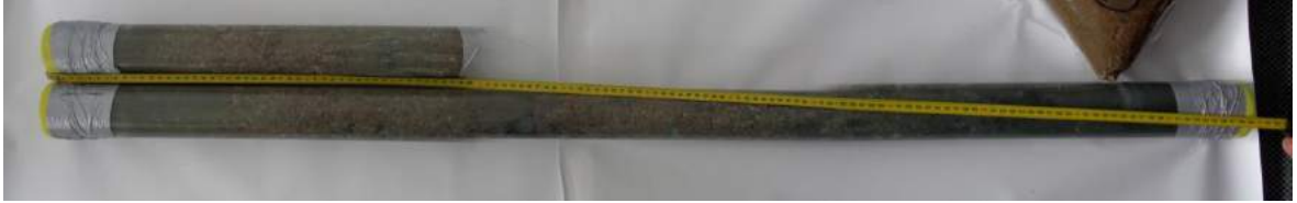
Fig. 49. Carottes réalisées au droit du point 1
