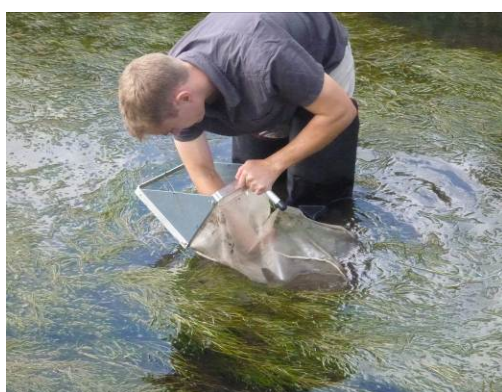
Photographie 14 : Prélèvement au filet surber
