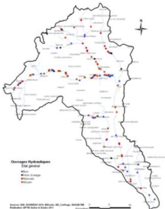
FIGURE 65: OUVRAGES HYDRAULIQUES TRANSVERSAUX
