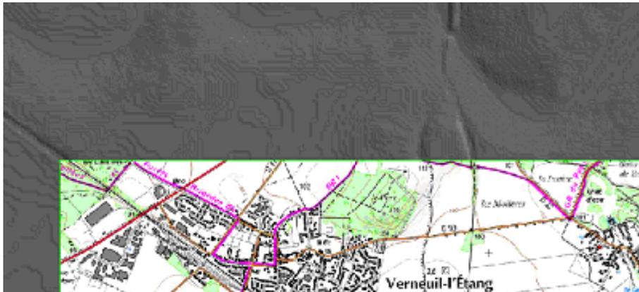
fig. 21) Illustration d'un ombrage généré sur MNT IGN 25 m qui montre les sauts de valeurs dont la trace correspond parfaitement aux courbes de niveau du SCAN25.
