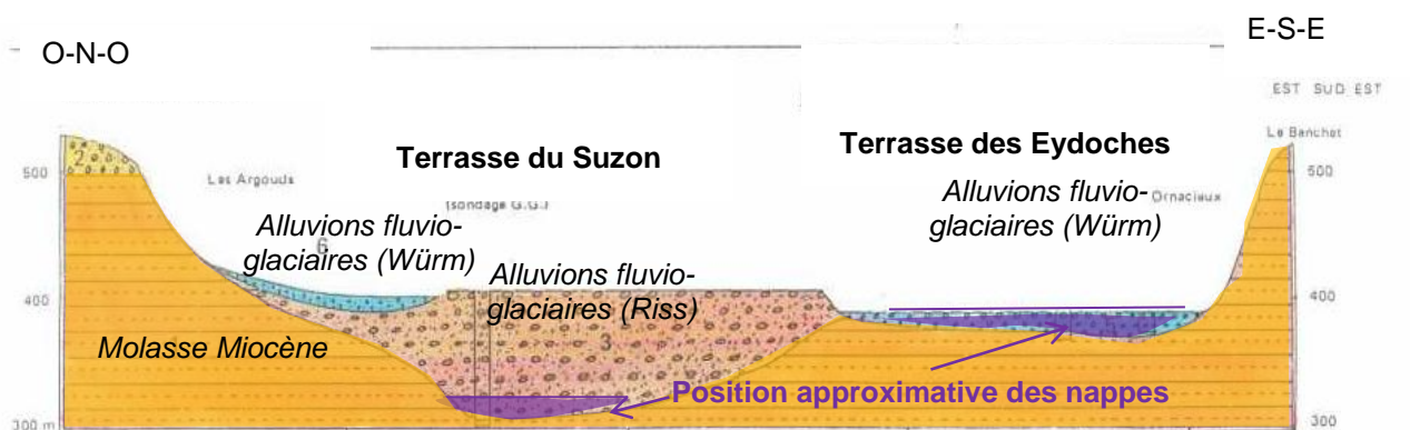
FIGURE 6. COUPE HYDROGEOLOGIQUE SCHEMATIQUE A TRAVERS LA PLAINE DU LIERS (SOURCE : (BRGM, 1994)), VOIR TRAIT DE COUPE EN FIGURE 7.
