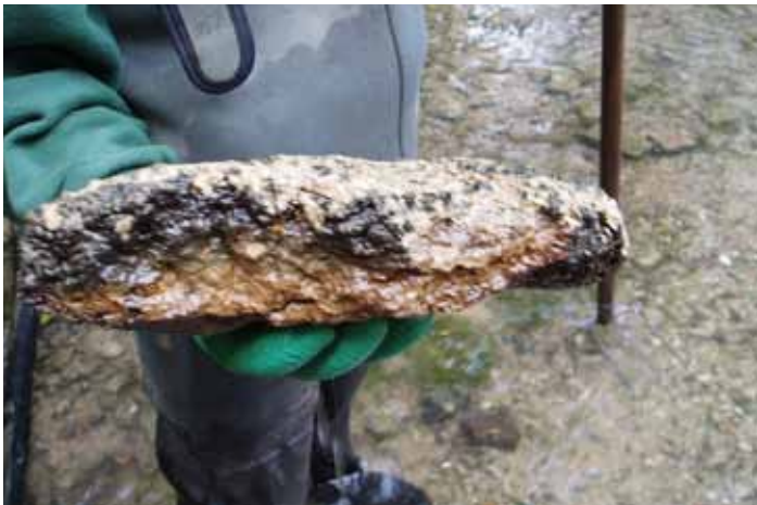
Concrétion calcaire présente sur plusieurs plateaux décolmatés
