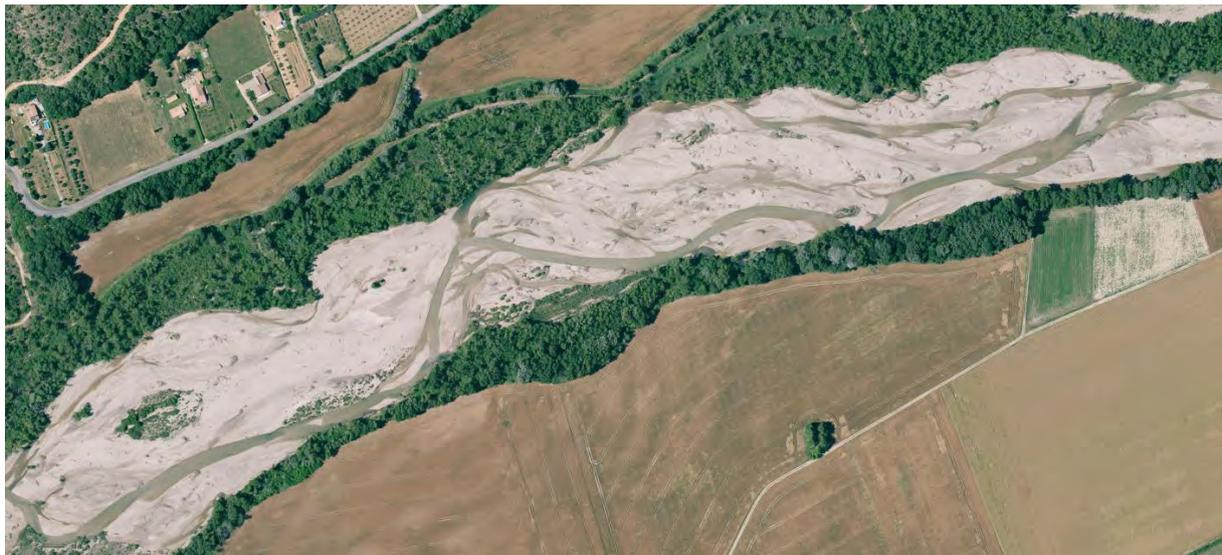
Figure 9 : Exemple de lit de type 4 - cours d'eau en tresses - (l'Asse, communes de Brunet et Saint-Julien-d'Asse, 04, source : Géoportail).
