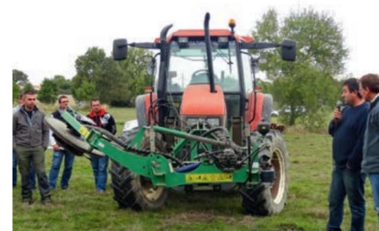
Présentation d'un broyeur sous clôture
