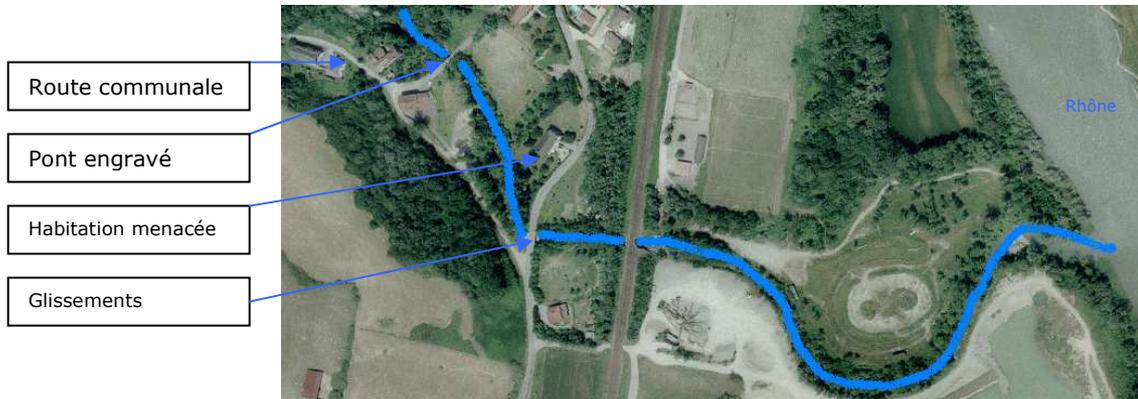
A la sortie de Pougny gare, une voie communale longe le cours d'eau en rive droite. La protection de berge, en enrochements, est partiellement déstabilisée en partie amont. On note un engrèvement important du pont en rive gauche.
