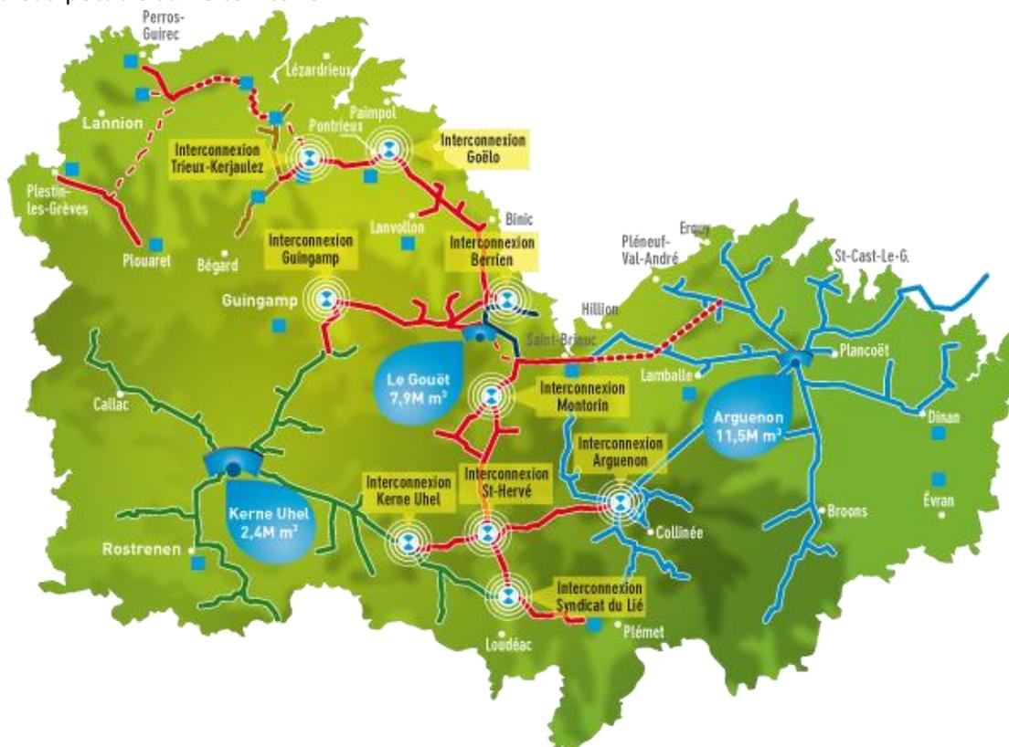
Figure 39 : Réseau structurant de transport d'eau potable
