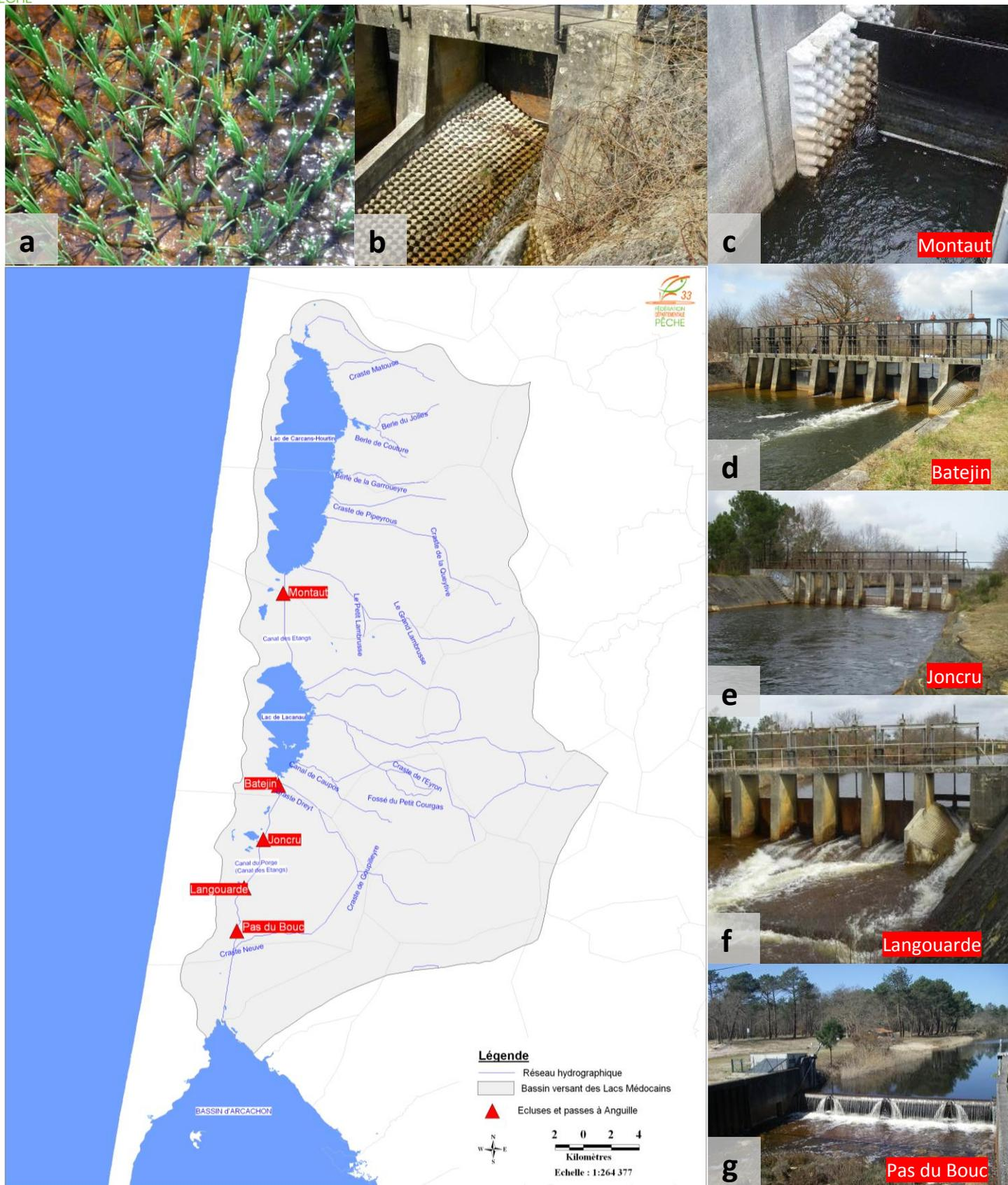
Figure 4: Bassin versant des Lacs Médocains, réseau hydrographique, écluses (c, d, e, f et g de l'amont vers l'aval) et passes à anguille (de type substrat brosse (a) et plots béton (b)) (©FDAAPPMA 33)
