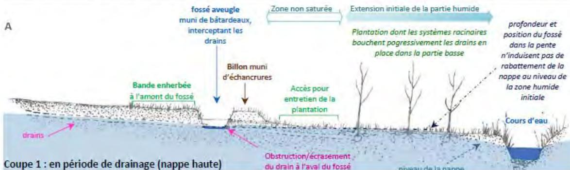
Positionné en amont de la partie humide, en « zone sèche », le fossé aveugle intercepte les drains, mais ne draine pas la partie humide.
