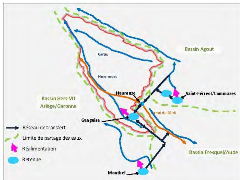
Figure II. 2 : Schéma des transferts interbassins autour de la retenue de la Ganguise
