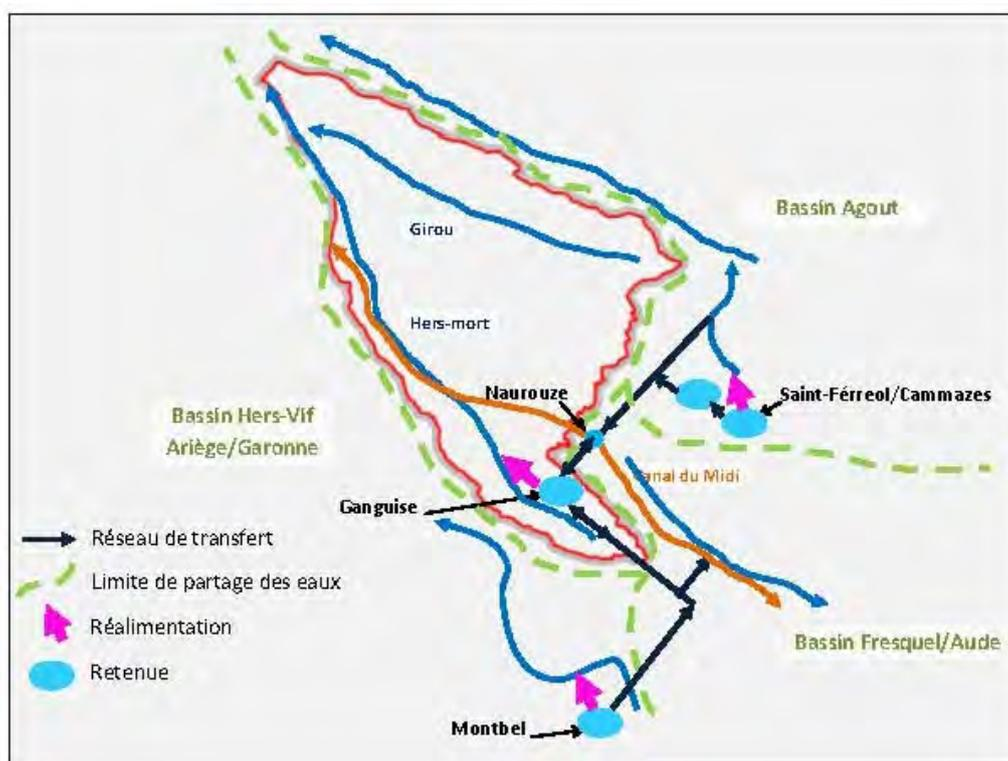
Figure I. 10 : Schéma des transferts interbassins autour de la retenue de la Ganguise
