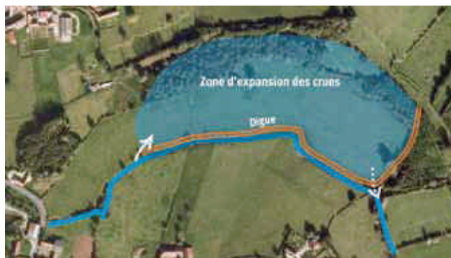
Photo 14 : Exemple d'aménagement d'une zone d'expansion des crues (Z.E.C.).
