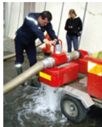
Essai d'un poteau incendie (source : Irstea)
