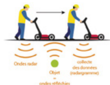
Principe de la géodétection (source : I.D.R.S)
