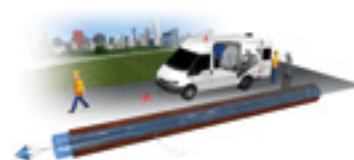
Introduction d'un hydrophone lié Sahara® (source : Pure Technologies)
