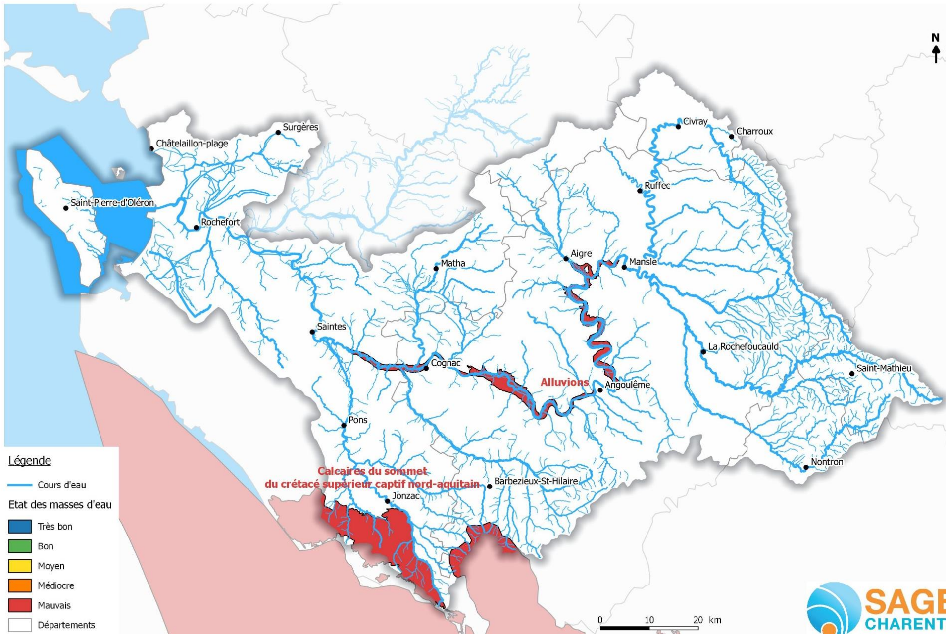
Carte n°5e : Etat des masses d'eau souterraines
