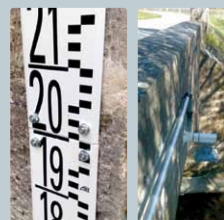
Echelle limnimétrique et radar de mesure des niveaux d'eau
