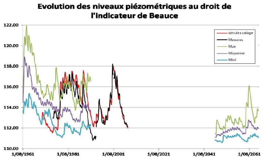
Figure 9 : Modélisation globale du BV de la Conie : calage de la modélisation et évolution des niveaux piézométriques (source : Explore 2070)
