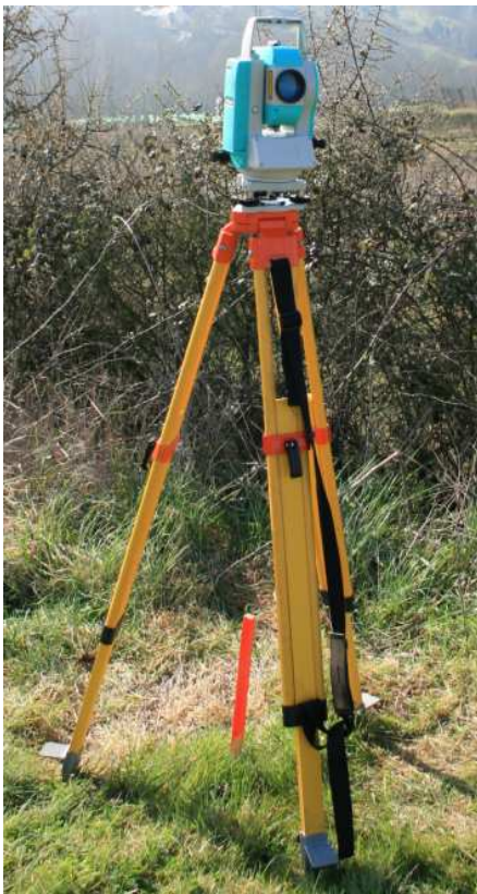
Figure 2 : Le théodolite électronique mis en station, soutenu par son trépied. Source : Romain Vallée, 2009.
