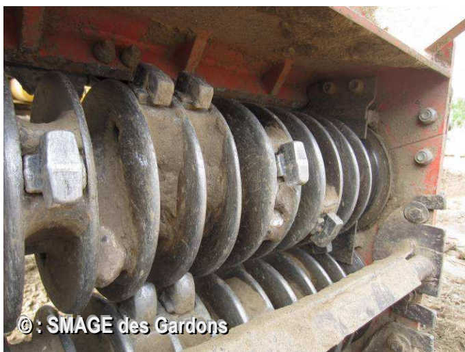
© : SMAGE des Gardons Présentation des rotors et de la barre de broyage du godet
