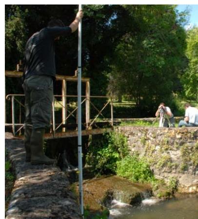
*Figure 5 : Mesure de la hauteur de chute à l'étiage*
