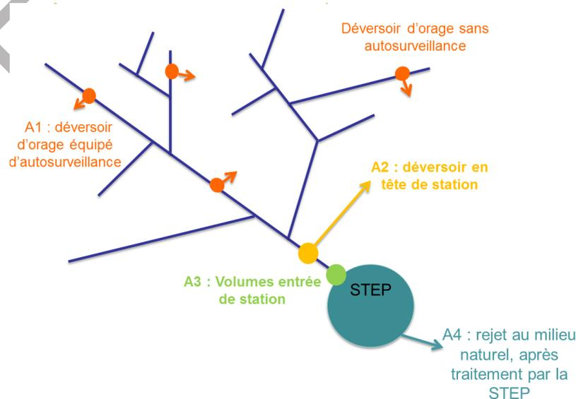
Schéma d'un réseau d'assainissement et localisation des différents points de rejets
