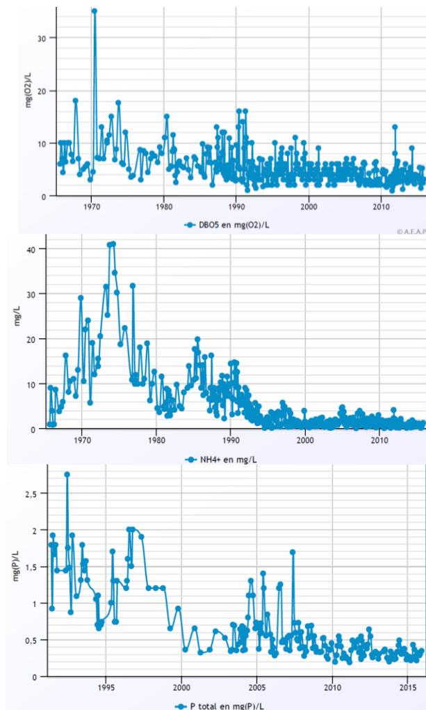
Evolution des teneurs demande biochimique en oxygène à 5 jours (DBO5), ammonium (NH<sub>4</sub><sup>+</sup>) et phosphore total à la station de suivi Scarpe canalisée à Nivelles (01041000).
