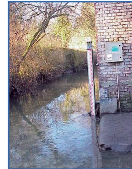
Exemple d'une échelle limnimétrique
