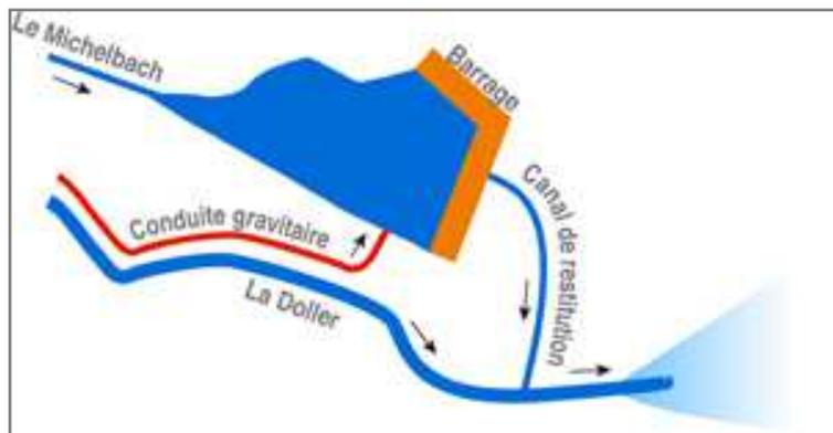
Figure 29 : fonctionnement du barrage de MICHELBAACH
