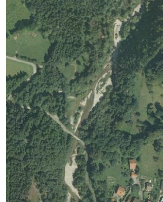
Phénomène de stockage des sédiments dans la retenue du barrage de stabilisation RTM sur le Brevon
