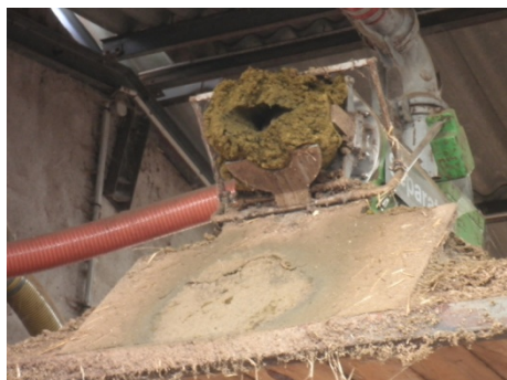
Séparateur de phase pour déshydrater le lisier
