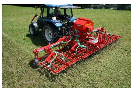
La herse étrille avec semoir pneumatique intégré
