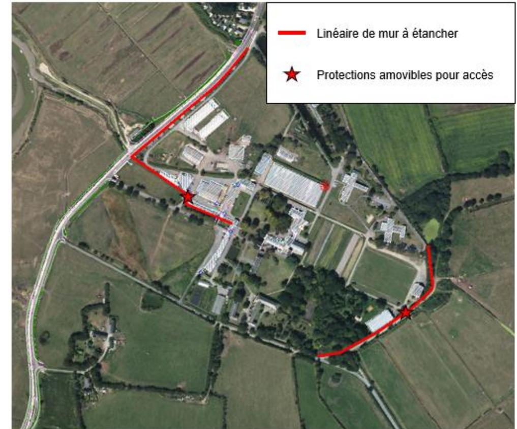
**Scénario 2A - Protection de l'ensemble des bâtiments et équipements par étanchéification des murs d'enceinte et mise en place de protections amovibles sur les accès**
