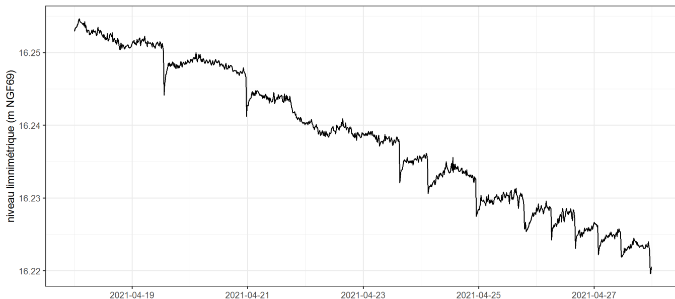
Figure 63. Exemple de probables signaux de pompage dans le fossé de la digue centrale (M_L2).
