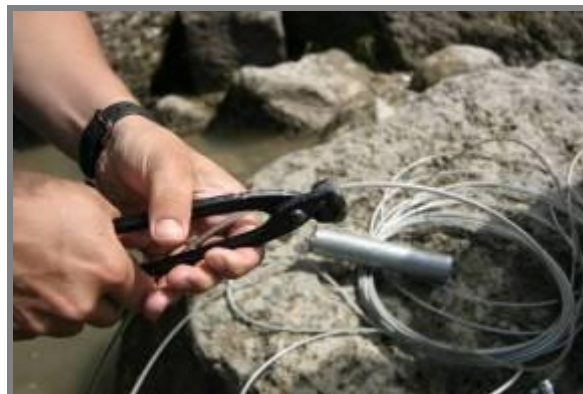
Installation d'un thermographe
