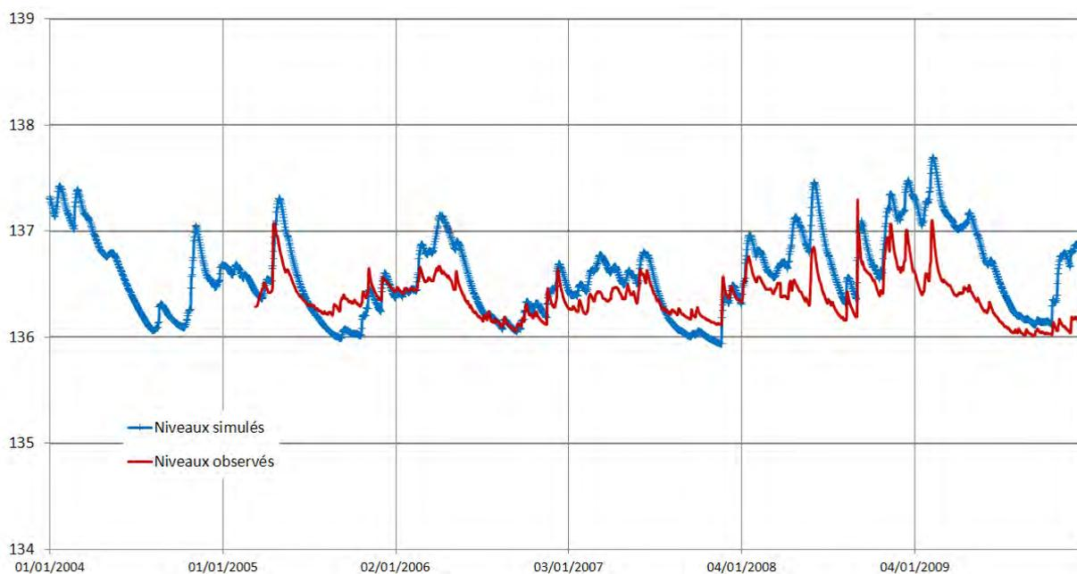
FIGURE 3.26 – Calage du modèle en régime transitoire au point d’observation d’Alex (SMRD) ; ce piézomètre n’étant pas nivelé, sa chronique n’est donné qu’à titre indicatif, permettant d’observer la comportement relatif de la piézométrie.
