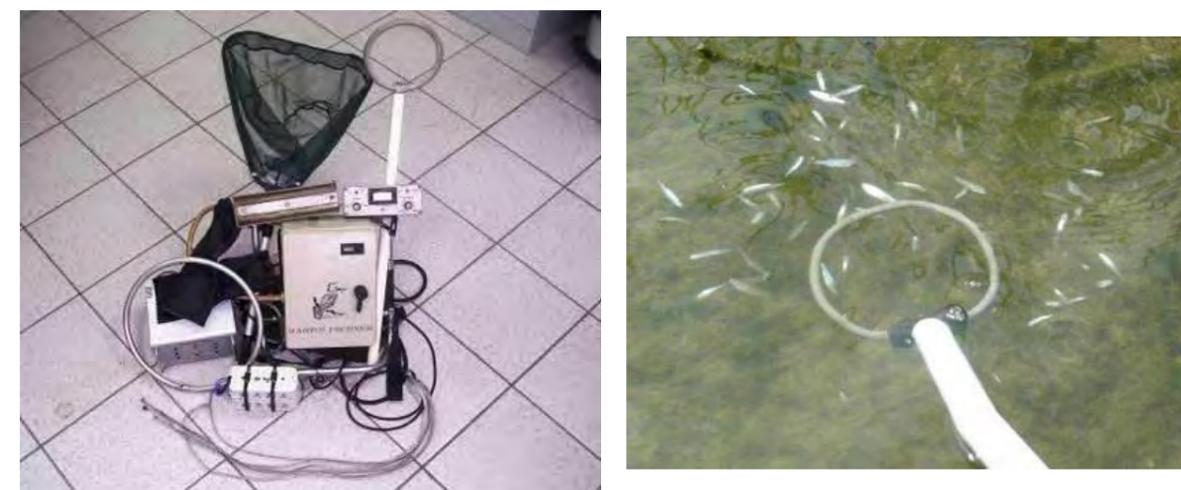
Figure 10 : Matériel de pêche électrique « martin pêcheur » et alevins immobilisés par le courant électrique (source : Hydrosphère)
