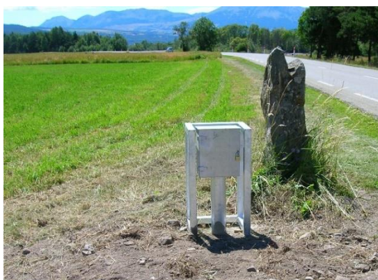
Réhabilitation du piézomètre S4 © CLEDA
