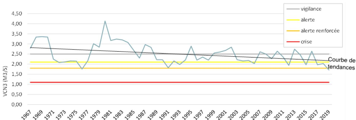
Figure 9 : évolution des débits d'étiage entre 1967 et 2019 - station hydrologique de Schweighouse sur Moder aval
