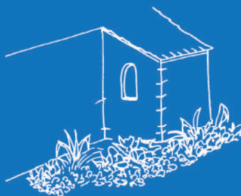
Absence d'espacement entre le massif de vivaces et le mur
