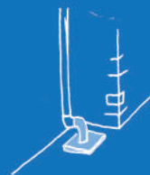
En souterrain : diriger le flux dans le regard (en contexte contraint et très minéralisé)
